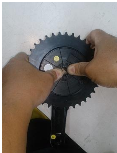
⑤新しいギアクランクにセンサーを取り付けます
