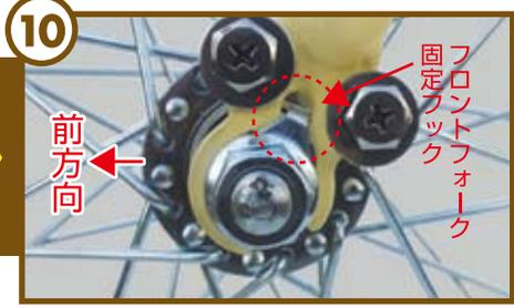
フロントフォーク固定フックを左右ともしっかり取り付けて固定してください。※(しっかりと固定する。)
