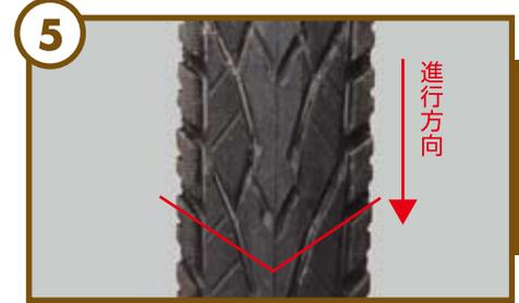
フロントフォークを差し込む前に前輪タイヤの向きを確認してください。※(前輪タイヤの溝の方向に注意)
