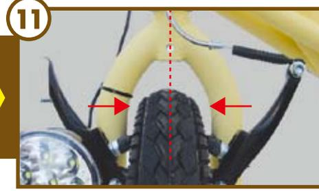
左右のナットは、タイヤがフロントフォークのセンターになるように調整しながらバランスよく締めてください。タイヤがセンターで無かったり、ナットの締まりがゆるいとブレーキは左右対称に握れません。(ナットはしっかりと締めてください。)
