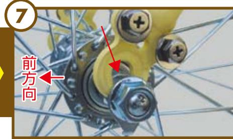
保護キャップを外し、フロントフォークを前輪タイヤの軸(指定箇所)に合わせて奥までしっかりと差し込んでください。
