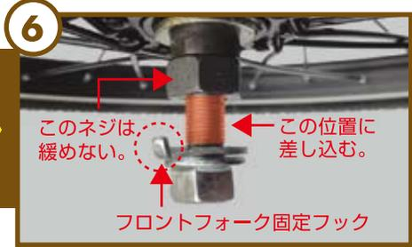
前輪タイヤの軸(赤で表した位置)にフロントフォークを差し込みます。※(上記のネジは絶対に緩めない。)
